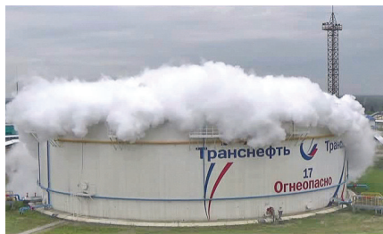
Рис. 3. Выпуск CO 2 в РВСП-20000 на ЛПДС «Южный Балык»
